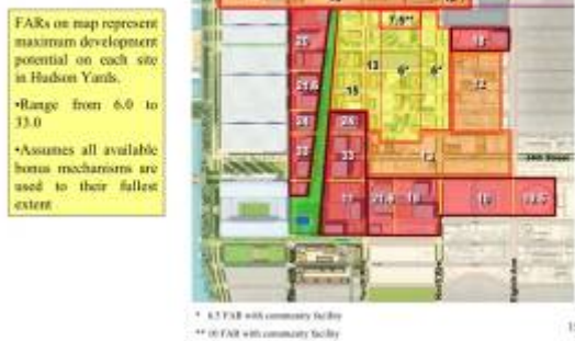
fig.地区改善容積率ボーナス（DIB）や容積率移転を適用した最大容積率ボーナスの分布
